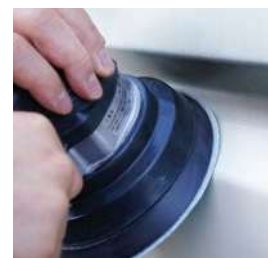
Lixamento de quinas
